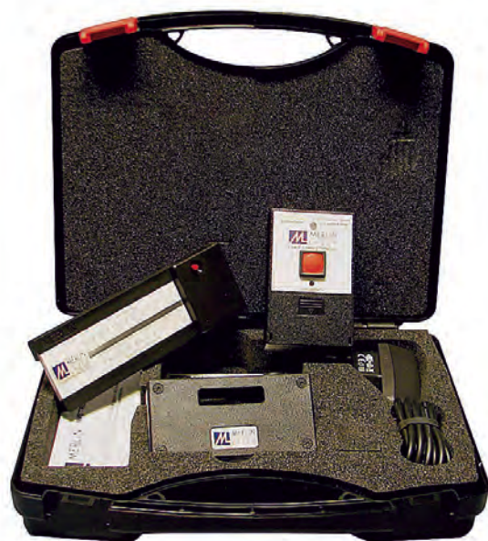
Deze glasanalyseset bevat een glasdiktelaser, een gehardglasindicator en een low-E-detector om de aanwezigheid en de locatie van een eventuele coating te bepalen
